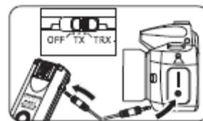
4. Presione hasta la mitad el botón multi funcional del transceptor en la mano y la cámara se enfoca. Así que la luz indicadora de enfoque se ilumina en verde. Si presiona el botón mencionado hasta el fondo, la cámara tomará una foto mientras la luz indicadora del obturador se ilumina en rojo.
