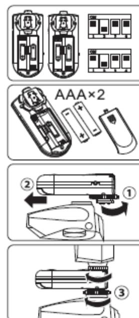
**4. Fijación del transceptor en el trípode o en el soporte del flash**
